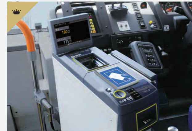
運賃箱 ICカードリーダー Farebox Smart Card Reader
