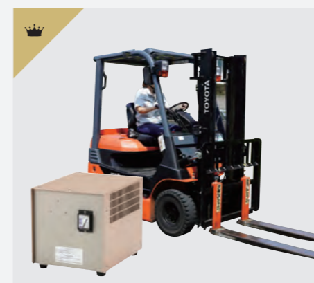
バッテリー式フォークリフト用充電器 Forklift Battery Recharging Unit
